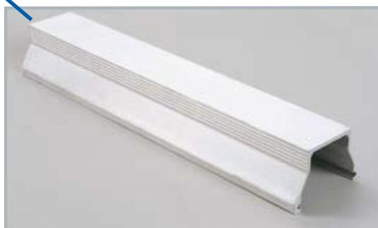
As fôrmas são fabricadas com perfis extrudados de alumínio, de ligas 606 I e 626 I, têmpera 6, os quais se unem embutidos entre si, com soldas de alumínio 5356. Reforços transversais de 7,5 cm garantem um melhor comportamento à deformação dos painéis em serviço.
