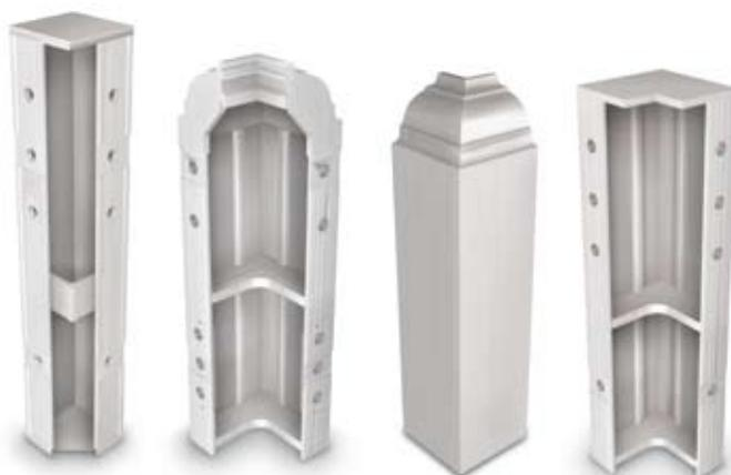
Para facilitar a desfôrma das paredes e a união parede-laje, a altura total dessa cantoneira se divide em duas seções de forma que a parte inferior possa ser desformada, quando da retirada das fôrmas de parede, para utilização na próxima concretagem. A parte superior é retirada após a união parede-laje.
