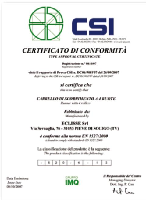
O certificado garante a confiabilidade das roldanas em função de uma série de testes feitos periodicamente com ciclos de 100.000 aberturas/fechamento. Considerando uma utilização normal numa habitação, é equivalente a 30 anos de funcionamento.
