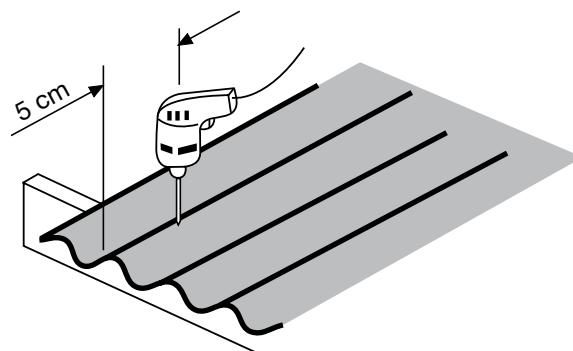
**Observação:** evite o aperto excessivo nas fixações sob o risco de trincas nas telhas.
