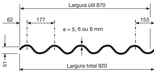
**Importante:** para edificações com pé-direito superior a 7 m, utilizar telhas de 6 ou 8 mm de espessura.
